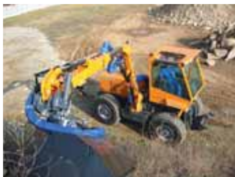
Le siège peut pivoter de 45° à droite pour améliorer la visibilité et l'ergonomie quand on utilise la flèche latérale.
