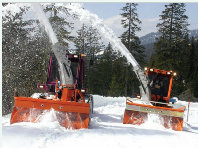
Frese da neve montate sul trattore porta-attrezzi MM 150 VR, il braccio articolato laterale, quando non in uso, può essere rimosso in pochi secondi
