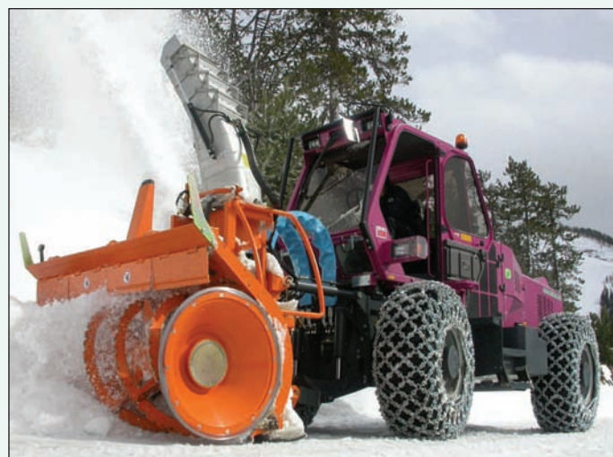
Frese da neve montate sul trattore porta-attrezzi MM 150 VR, il braccio articolato laterale, quando non in uso, può essere rimosso in pochi secondi
