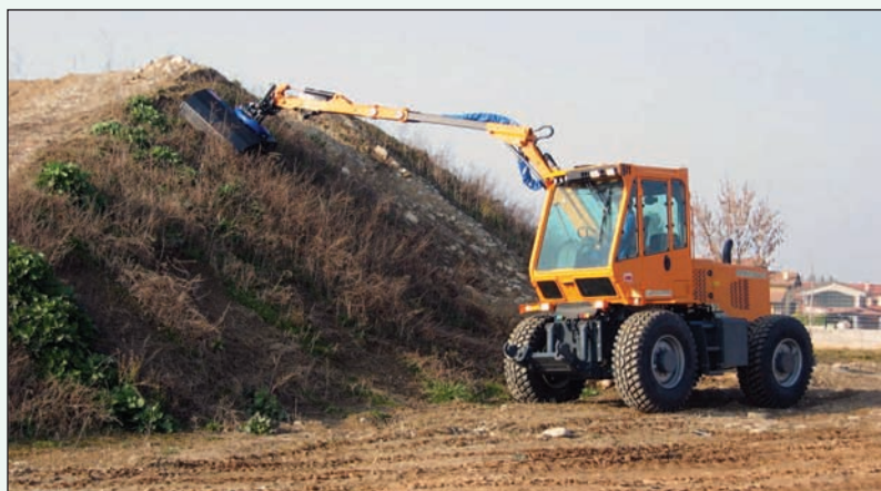
Il braccio telescopico laterale rende accessibile anche la scarpata più scoscesa
