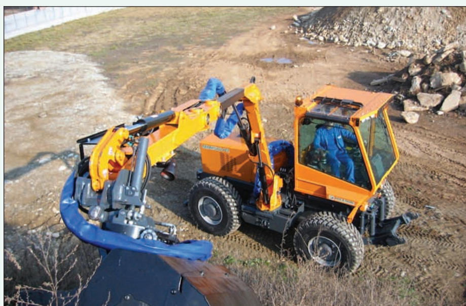
Il sedile può ruotare di 45° verso destra per migliorare la visibilità e l'ergonomia quando si utilizza il braccio laterale
