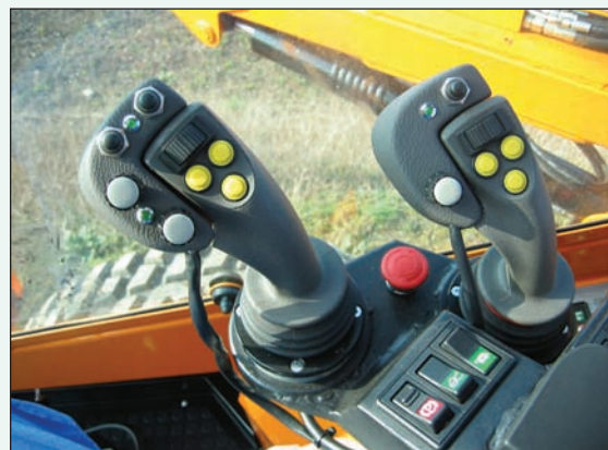
I comandi joystick permettono il controllo di tutte le funzioni di lavoro
