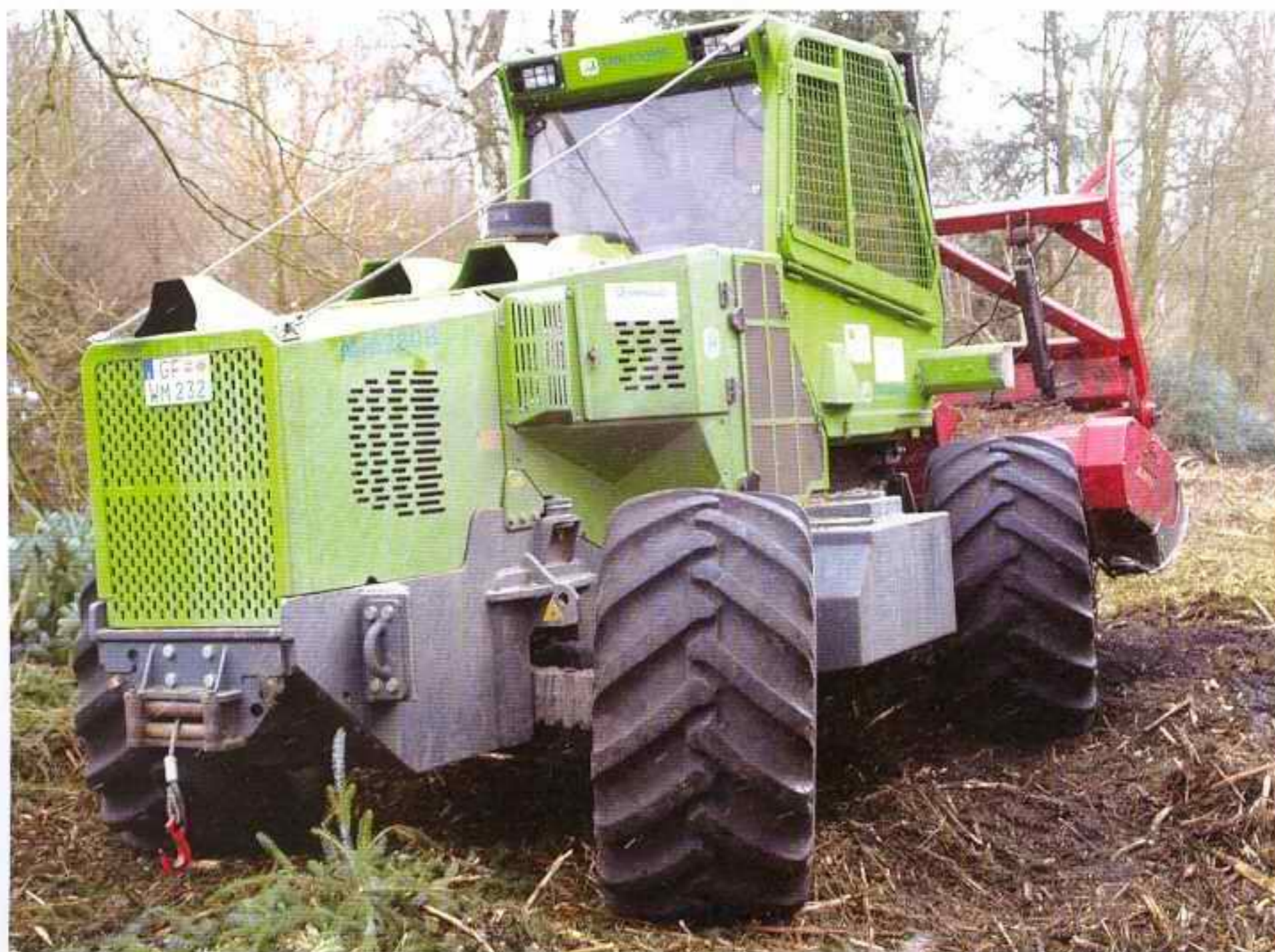
Drei Lenkarten beherrscht der MM280B, Vorderachslenkung, Allradlenkung und die sogenannte Hundeganglenkung.
