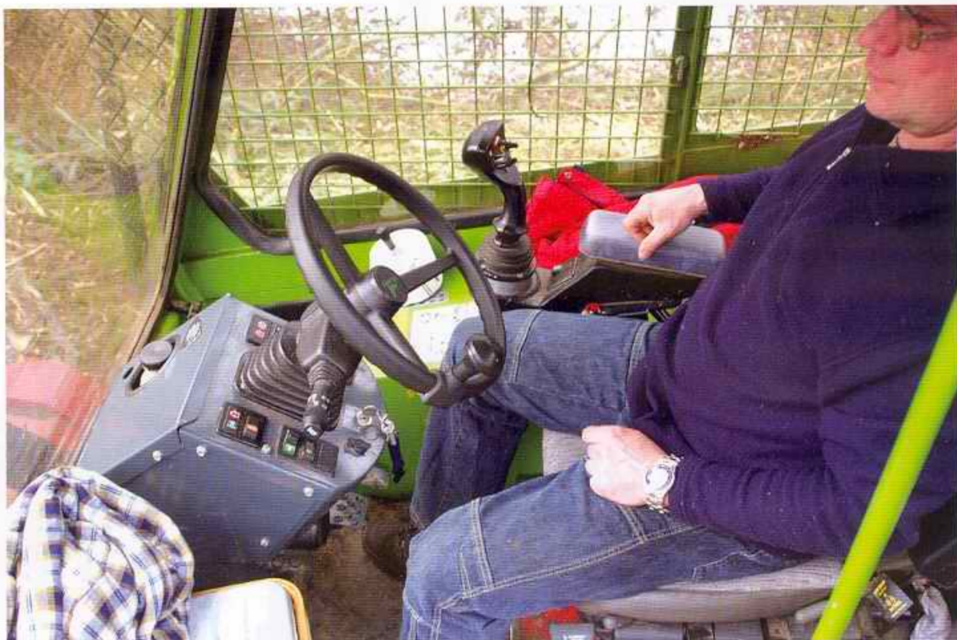
Ein Blick in die Kabine. Die Steuerung der Hydraulik und der Arbeitsfunktionen geschieht über einen Joystick.
